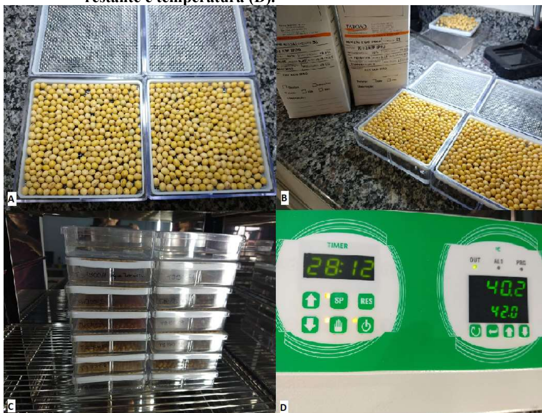
Figura 3 – Sementes colocadas sobre as telas em camadas simples, preenchendo todo o fundo (A) e (B); sementes nas caixas gerbox dentro da câmara de envelhecimento acelerado (C); visor da câmara com informações de tempo restante e temperatura (D).
