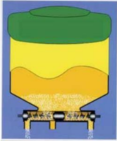
Figura 4: Esquema de um distribuidor em linha de fertilizantes com dosador do
